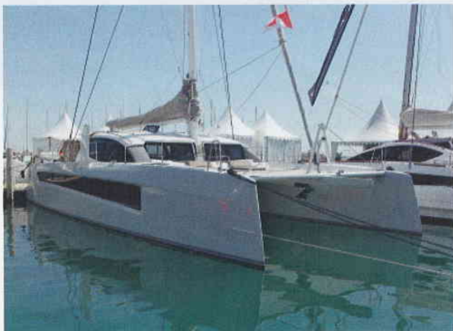
Longueur : 14,95 m. Largeur : 7,68 m. Tirant d'eau : 1,10-2,20 m. Déplacement : 11600 kg. Surface de voile : 128 m². Architecte : iYacht GmbH. Chantier : Slider Catamarans. Prix : 718 800 €.
